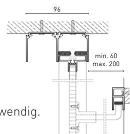
Wird bei Schrägtüren unter einer Dachschräge notwendig.
