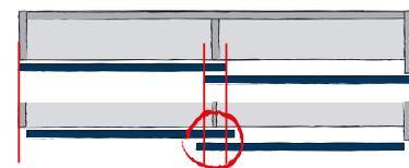
Die Mittelseite als Einflussgröße auf den Türeinsprung: eine dünnere Mittelseite vergrößert bei gleicher Türbreite den Türeinsprung.
