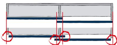
Die Türauflage als Einflussgröße auf den Türeinsprung: eine kleinere Türauflage vergrößert bei gleicher Türbreite den Türeinsprung.
