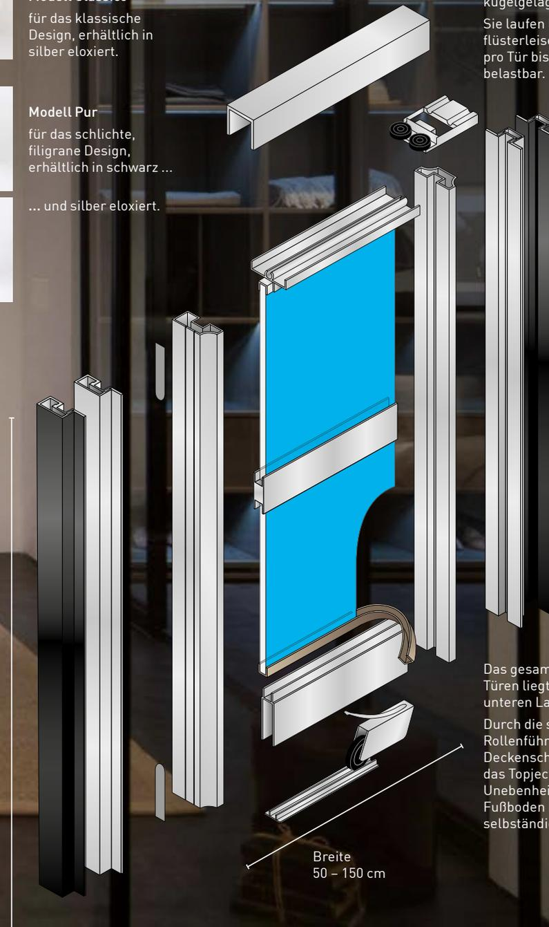
Das gesamte Gewicht der Türen liegt auf der unteren Laufrolle. Durch die seitliche Rollenführung in der Deckenschiene gleicht das Topject-System Unebenheiten im Fußboden bis zu 15 mm selbständig aus.
