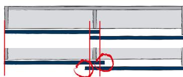
Eine größere Türüberdeckung aufgrund einer größeren Tür vergrößert den Türeinsprung.
