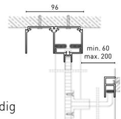
Wird bei Schrägtüren unter einer Dachschräge notwendig
