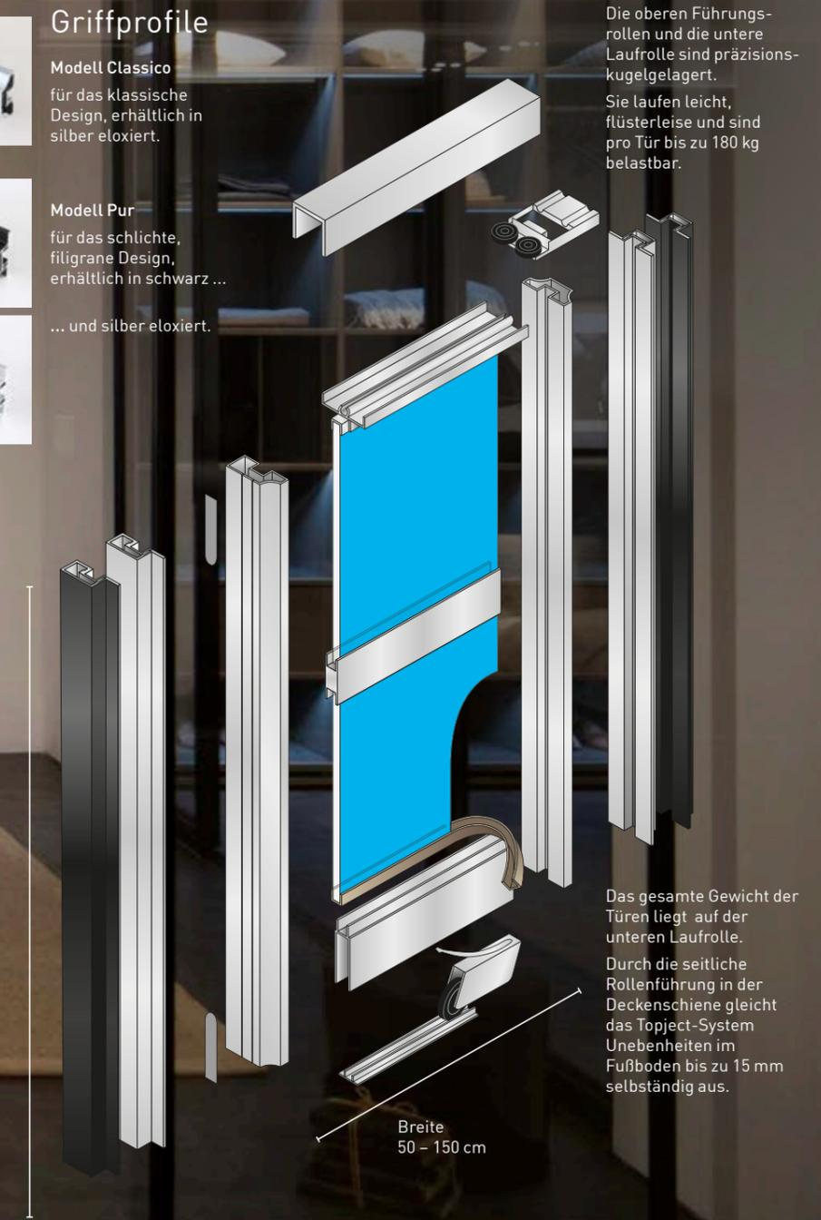
Das gesamte Gewicht der Türen liegt auf der unteren Laufrolle. Durch die seitliche Rollenführung in der Deckenschiene gleicht das Topject-System Unebenheiten im Fußboden bis zu 15 mm selbständig aus.
