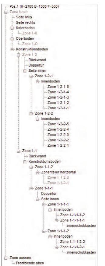
Ausgehend von der Korpushülle als Basis werden die einzelnen Zonen in sich verästelnden Hierarchien eingesetzt und stehen in permanenter Abhängigkeit zueinander.
