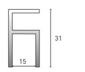
Führungsprofil für hintere Führung
