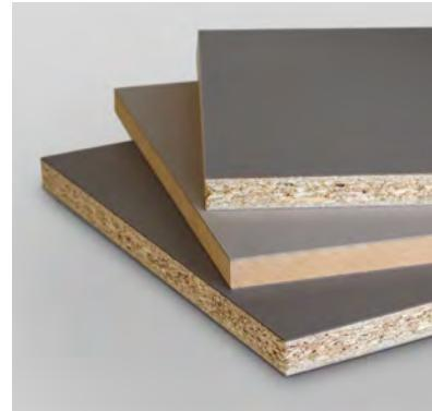
Die möglichen Produktvarianten sind durch die freie Kombination von Trägerplatten und Schichtstoffen nahezu unbegrenzt. Für die Herstellung von Schichtstoffverbundplatten werden in erster Linie die ab Lager Pfleiderer verfügbaren Schichtstoffe in der Nenndicke 0,8 mm genutzt. Die Verbundplatten haben unabhängig vom Schichtstoff die Abmessungen 2.800 x 2.070 mm.
