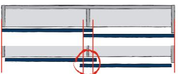
Die Türauflage als Einflussgröße auf den Türeinsprung: eine kleinere Türauflage vergrößert bei gleicher Türbreite den Türeinsprung.
