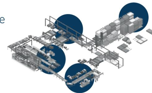
Vollautomatisches Lager, Zuschnitt, Nullfugen-Bekantung mit Laser- oder PUR-Verleimung, CNC-Bearbeitung, stückgenaue Beschlag-Konfektionierung, Verpackung.
