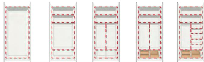
So entsteht eine Baumstruktur, in der sich alle Bauteile des Möbels wiederfinden. Genau wie im Baum und in den Ästen gibt es auch im Möbeldesigner Abhängigkeiten von Zonen und Bauteilen.
