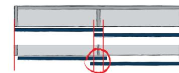
Die Mittelseite als Einflussgröße auf den Türversatz: eine dünnere Mittelseite vergrößert bei gleicher Türbreite den Türversatz.
