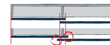
Eine größere Türüberdeckung aufgrund einer größeren Tür vergrößert den Türeinsprung.
