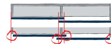
Die Türüberdeckung als Einflussgröße auf den Türeinsprung: eine kleinere Türauflage vergrößert bei gleicher Türbreite den Türeinsprung.
