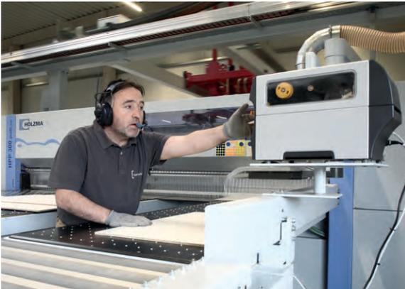
**Der Zuschnitt.** Auf liegenden Plattensägen werden Holzwerkstoffplatten bis zu einem maximalen Maß von 4.100 x 2.070 mm zugeschnitten. Durch die Anbindung an das Plattenlager wird jede Platte mittels Vakuum und damit gerade bei empfindlichen Oberflächen absolut schonend transportiert.
