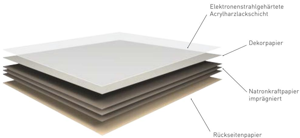
Egger-Schichtstoff „PerfectSense Topmatt“ ist ein dekorativer Schichtstoff (Typ HGS) auf Basis härthbarer Harze. Die oberste Papierschicht wird in einem gesonderten Herstellungsprozess lackiert und anschließend elektronenstrahlgehärtet.
