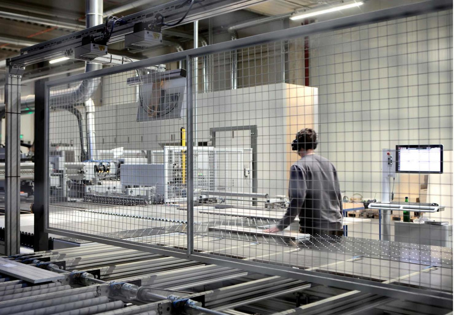
Die Kantenanleimung. Die Kante sorgt für die „gefühlte“ Qualität des Möbelteils. Jede Kante wird je nach Dekor von Platte und Kante fugenlos mit weißem oder transparentem PUR-Kleber angeleimt oder per Lasertechnik verbunden.
